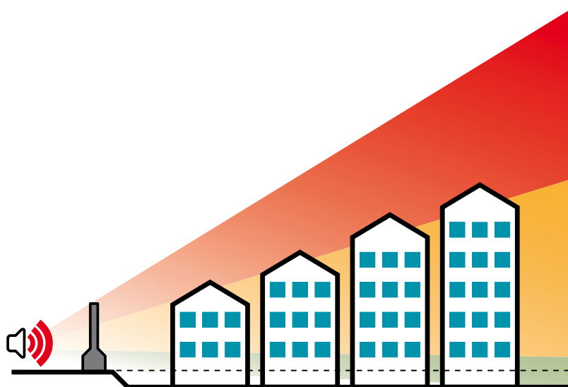
Effetto della barriera continua: attenuazione dB(A)
